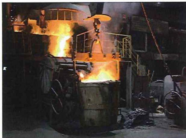
写真3 11t熱風キュボラ (水冷式ノーライニング)
