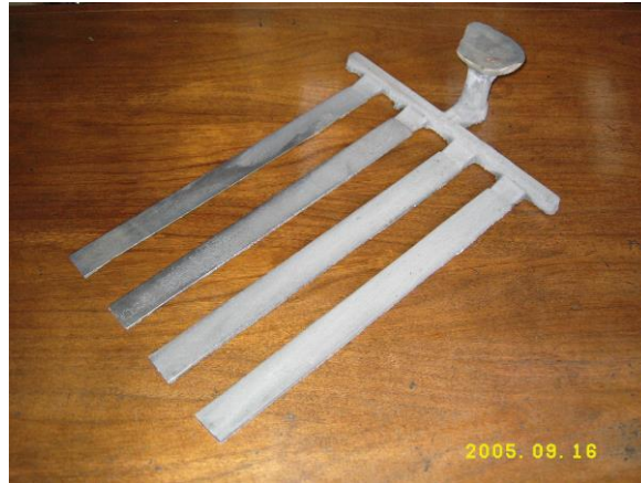
図5 板状湯流れ試験結果
